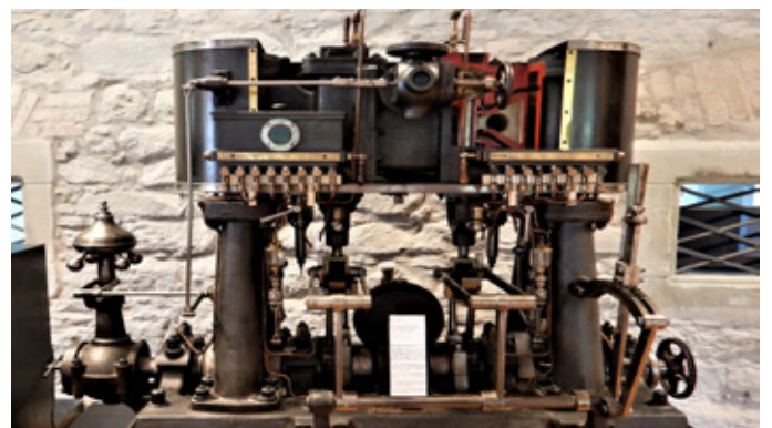
Im Eingangsbereich des Seemuseums Kreuzlingen befindet sich diese Zwillings-Compound-Dampfmaschine eines ehemaligen Baggerschiffs.
